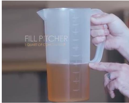
شكل رقم ٣٤: تجهيز ربع جالون من زيت التبريد
