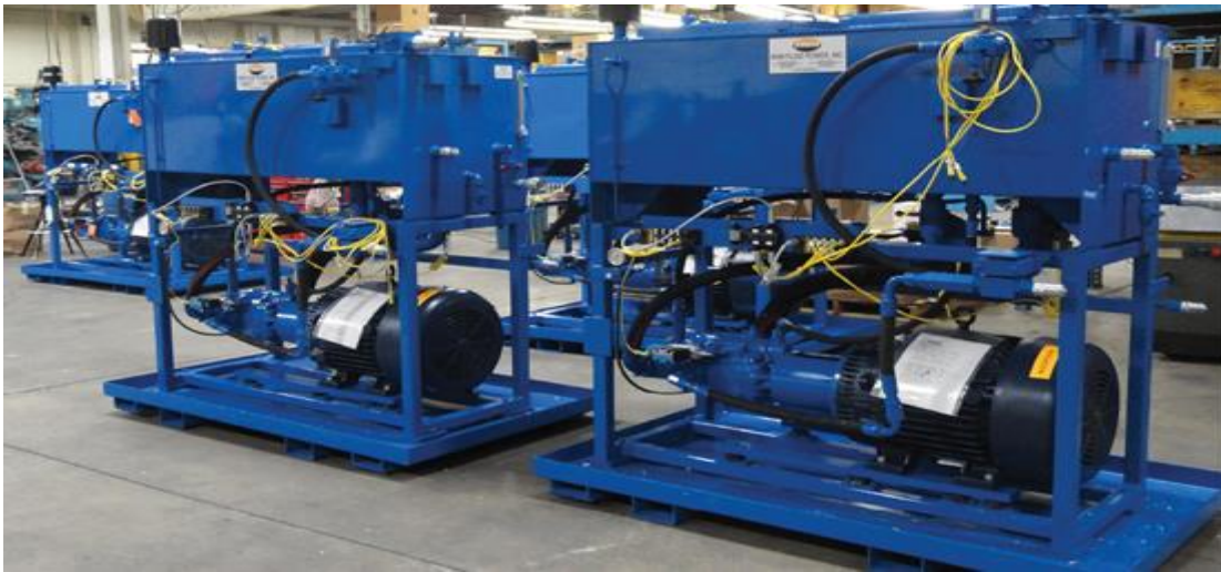
شكل رقم ٤٤: يوضح وحدة إنتاج القدرة الهيدروليكية ذات الخزان العلوي.
