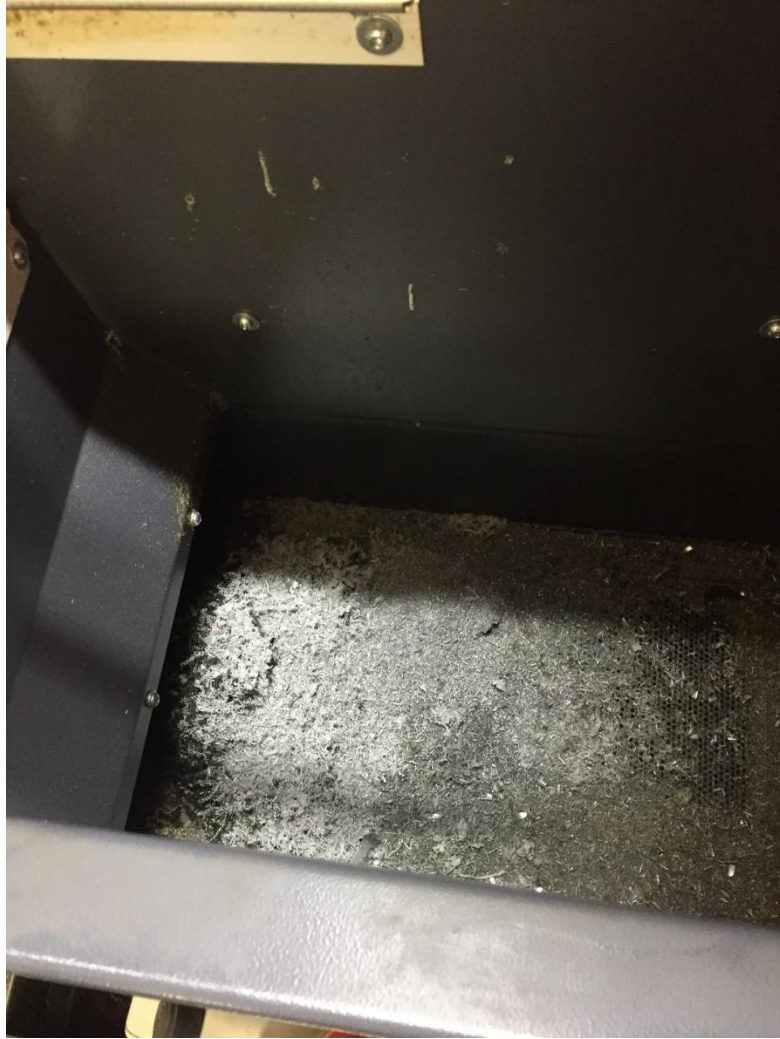
شكل رقم ٣: صندوق تجميع الرايش اسفل الظرف
