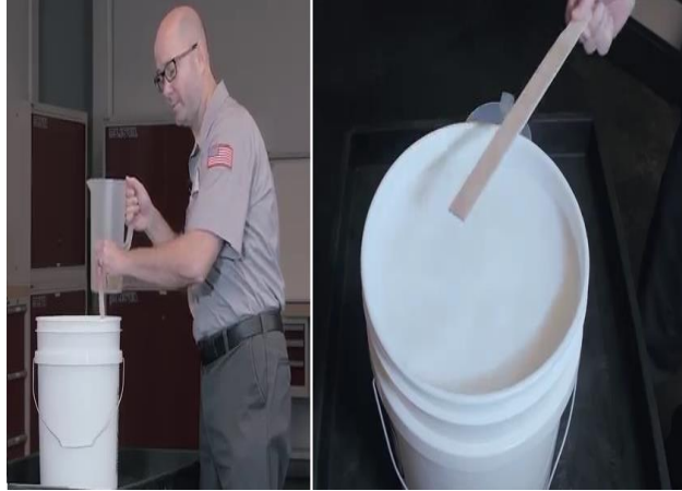
شكل رقم ٣٦: تقليب خليط زيت التبريد
