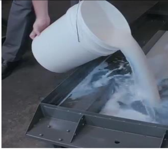
شكل رقم ٣٨: صب خليط زيت التبريد في درج الزيت
