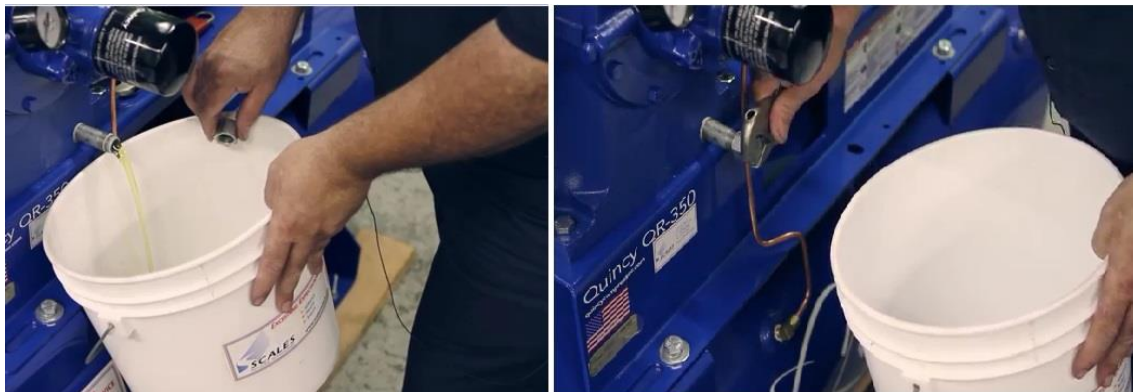
شكل رقم ١٧: تفريغ الزيت
