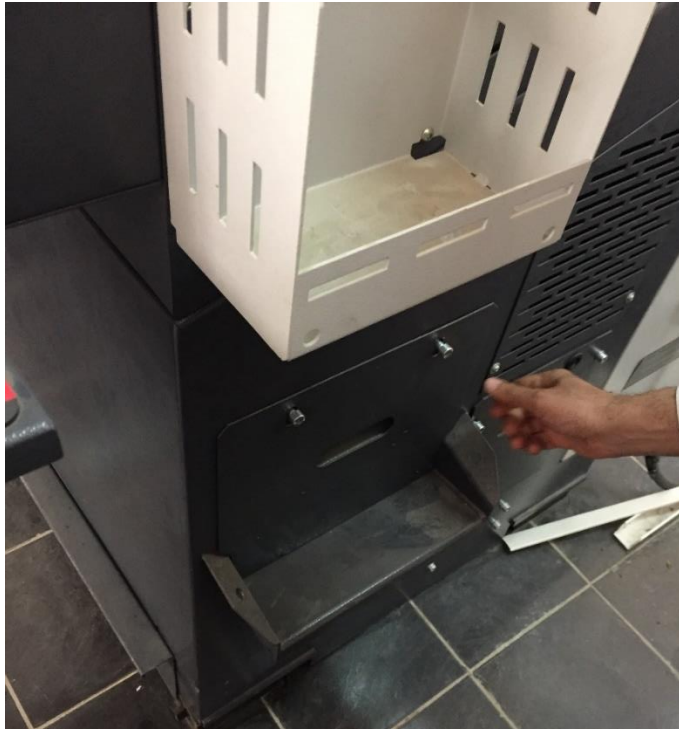
شكل رقم ٣٩: إعادة ربط حامل موتور زيت التبريد
