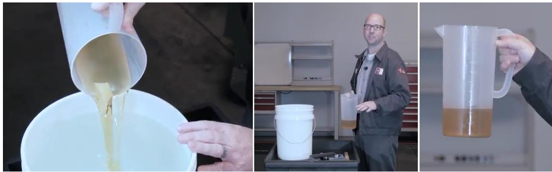
شكل رقم ٣٥: صب زيت التبريد المركز على الماء
