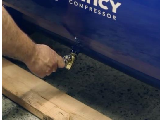
شكل رقم ١٦: تفريغ هواء الضاغط
