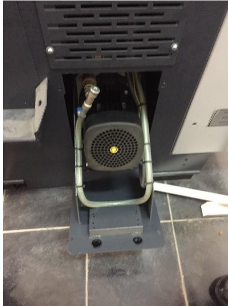
شكل رقم ٣٠: إنزال قاعدة حامل موتور ظلمبة زيت التبريد للخارج
