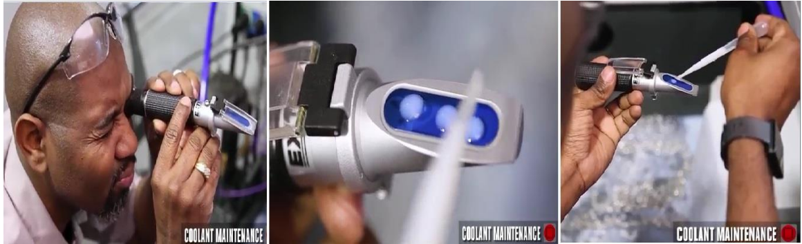
شكل رقم ٣٢: فحص عينة سائل التبريد
