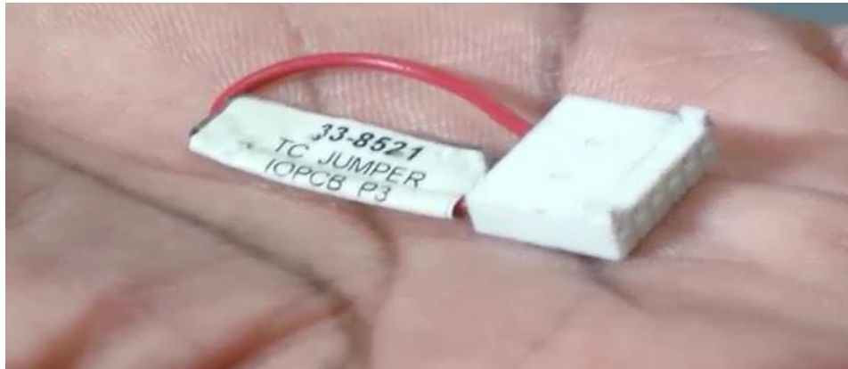
١٦- يقوم الطالب بإزالة وصلة كبل الحساس الخاضع للاختبار من لوحة ال I/O board وتركيب ال Jumper Cable بدلا منها.
