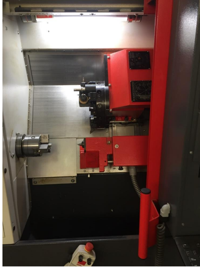
شكل رقم ٥: يجب فك الشغلة بعد انتهاء العمل
