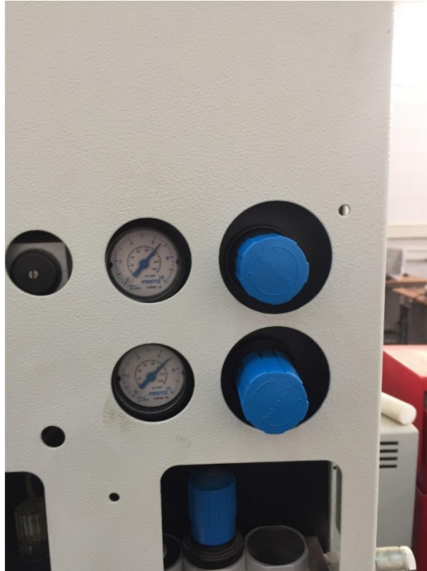
شكل رقم ٢٥: فحص ضغط عداد وحدة خدمة الهواء
