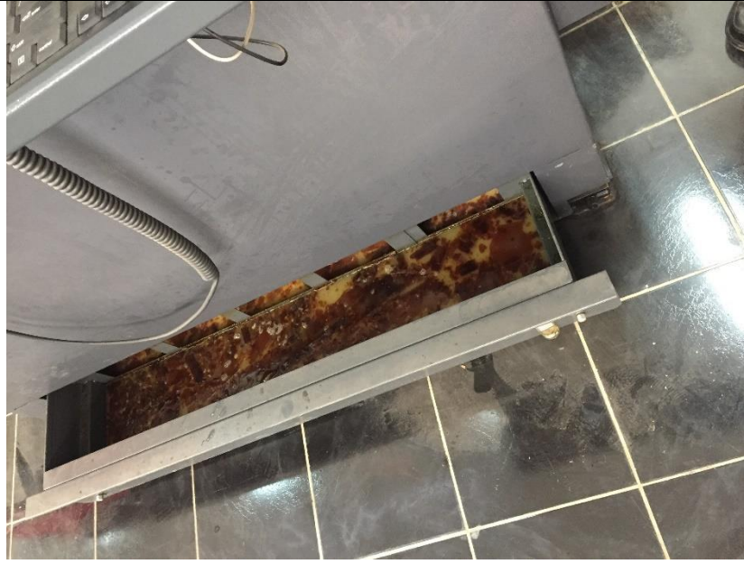
شكل رقم ٣١: سحب درج سائل التبريد من اسفل الماكينة
