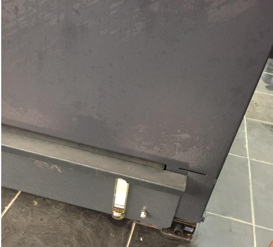
شكل رقم ٢٨: فحص مستوى الزيت من خلال مبين المستوى الزجاجي
