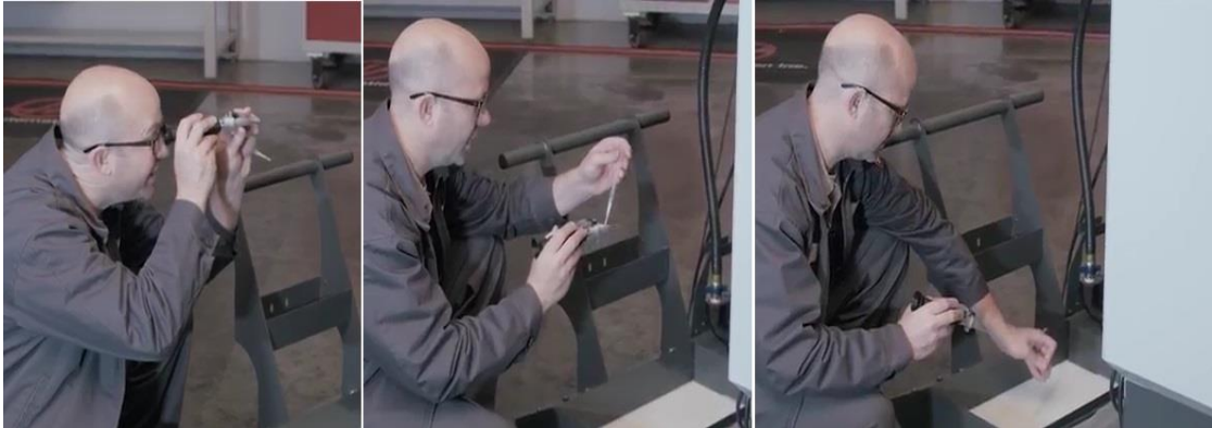
شكل رقم ٣٧: فحص عينة سائل التبريد
